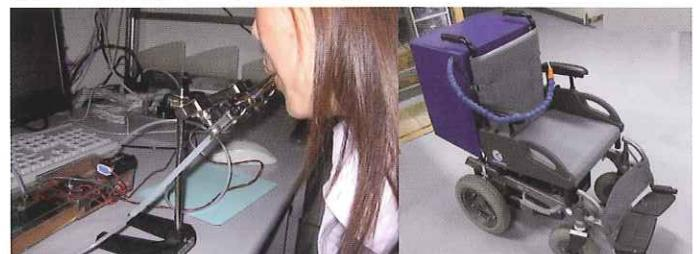
図2 呼気圧による電動車いすの操縦:
