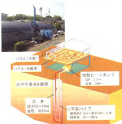
地中熱利用ヒートポンプ (GeoHP: Geothermal Heat Pump) システム
