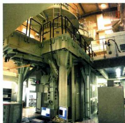
超高压電子顕微鏡
