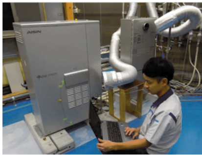
SOFC型エネファーム
