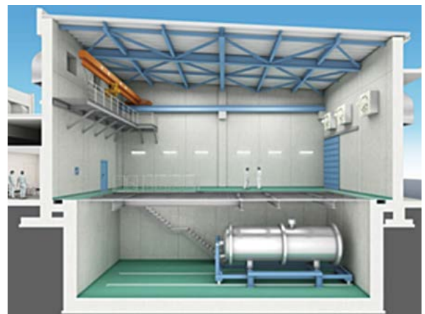
画像：高圧水素ガス試験室
