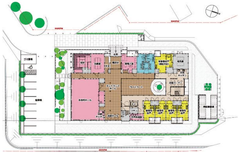
本施設整備費の約1/2は、「平成22年度福岡県森林整備加速化・林業再生事業」の補助金が使用されています。また、使用木材の内6割以上を福岡県産材としており木造公共施設として地域材の利用を喚起し木材の需要のさらなる拡大につなげ広く普及することも目的としています。3階建て木造建築としては福岡県内最大級の施設であり、構造は継手を拡張樹脂アンカー工法とした木造軸組工法とし小径の製材をつなぎ合わせ大断面の合成柱、梁とすることで建設コストを抑え、工法上金具が表面に出ないことから木の素材の良さをそのままに内外部に表現しています。
