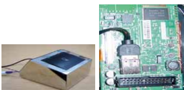
全タイプ対応カードリーダーと内臓回路基板
